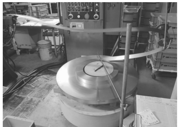
図3 プレス機械へ高速で送られる帯鋼
