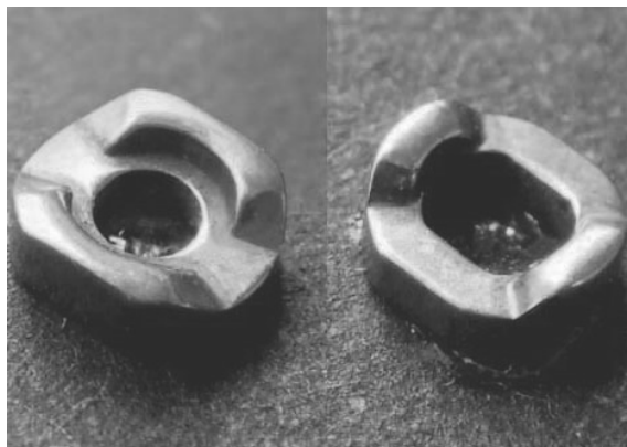
図7 プレス加工製品(鍛造代替品) 4)
