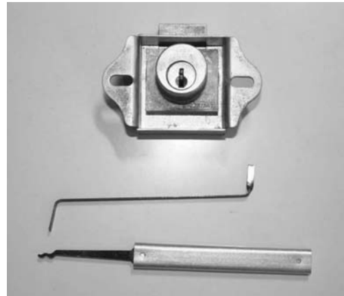
図9 ピンシリンダー錠とピッキングツール
