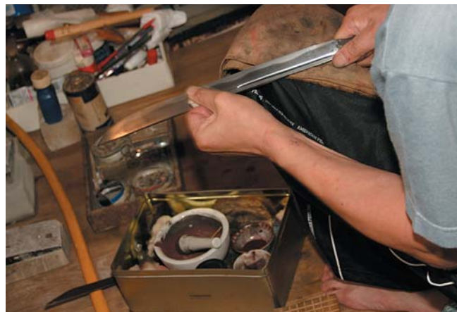
図5 拭いの様子(すり鉢に入っているのが酸化鉄の粉に丁子油を混ぜたもの)
