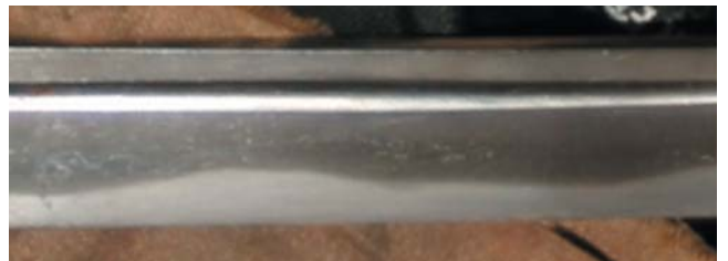
図4 地艶での地と刃の色(下側が刃)
